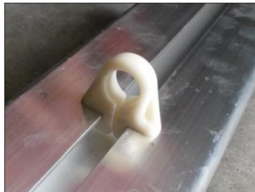
התקנת התפסן מתבצעת ע"י סיבוב התפסן ב-90 מעלות בתוך המסילה
